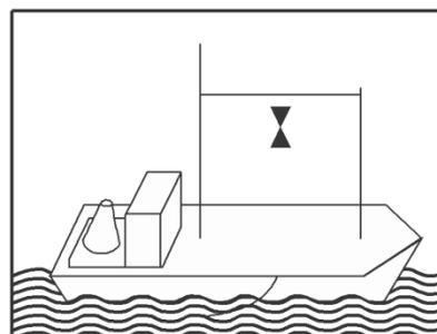
§ 3.35 Z 1: Zusätzliche Bezeichnung von Fahrzeugen, die ein Schleppnetz oder ein anderes Fischereigerät im Wasser ziehen (Schleppnetzfischer):
