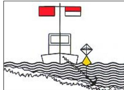
§ 3.26 Z 3, Beispiel für die Bezeichnung von schwimmenden Geräten, deren Kabel, Ankerketten oder Anker die Schifffahrt gefährden können:
