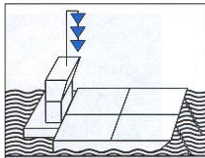
§ 3.21, zusätzliche Bezeichnung für stillliegende Schubverbände, die bestimmte explosive Stoffe befördern, für die nach Unterabschnitt 7.1.5.0 und Kapitel 3.2, Tabelle A, Spalte (12) des ADN folgende Bezeichnung vorgeschrieben ist:
