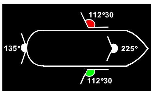
Lichter gemäß § 3.01: Der Horizontbogen, über den das Topplight, die Seitenlichter und das Hecklicht sichtbar sind
