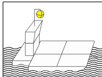
§ 3.10 Z 2, geschleppte Schubverbände, denen ein oder mehrere Fahrzeuge mit Maschinenantrieb als Vorspann vorausfahren:
