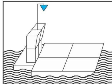
§ 3.14 Z 5, zusätzliche Bezeichnung für Schubverbände mit zwei schiebenden Fahrzeugen, die bestimmte entzündbare Stoffe befördern, für die nach Unterabschnitt 7.1.5.0 oder 7.2.5.0 und Kapitel 3.2, Tabelle A, Spalte (12) oder Tabelle C, Spalte (19) des ADN folgende Bezeichnung vorgeschrieben ist:
