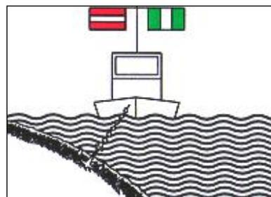
§ 3.25 Z 1 lit. a und b sowie Z 2 lit. a und b, Schwimmende Geräte in Betrieb und stillliegende Fahrzeuge, die Arbeiten, Peilungen oder Messungen ausführen, Durchfahrt frei an einer Seite:
