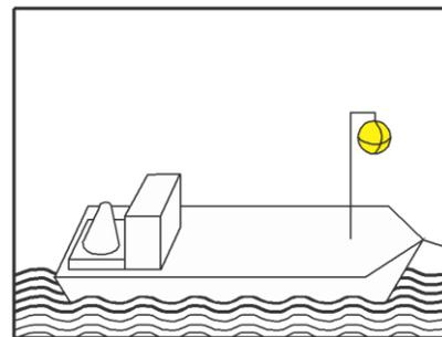
§ 3.08 Z 3, Fahrzeug mit Maschinenantrieb, dem vorübergehend ein Vorspann vorausfährt:
