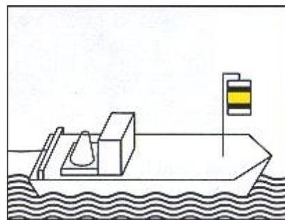
§ 3.09 Z 2, jedes von mehreren Fahrzeugen mit Maschinenantrieb an der Spitze eines Schleppverbandes oder jedes Fahrzeug des Vorspanns:
