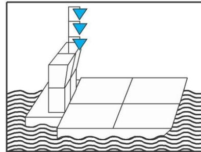
§ 3.14 Z 5, zusätzliche Bezeichnung für Schubverbände mit zwei schiebenden Fahrzeugen, die bestimmte explosive Stoffe befördern, für die nach Unterabschnitt 7.1.5.0 und Kapitel 3.2, Tabelle A, Spalte (12) des ADN folgende Bezeichnung vorgeschrieben ist:
