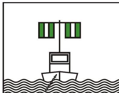
§ 3.25 Z 1 lit. a und Z 2 lit. a, Schwimmende Geräte in Betrieb und stillliegende Fahrzeuge, die Arbeiten, Peilungen oder Messungen ausführen, Durchfahrt frei an beiden Seiten:
